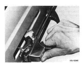
9 Insert pivot rod into pivot nut.
